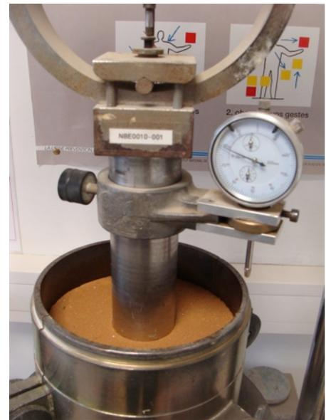
Fig. 1.7 Mesure de l'IPI, indice de portance immédiat
