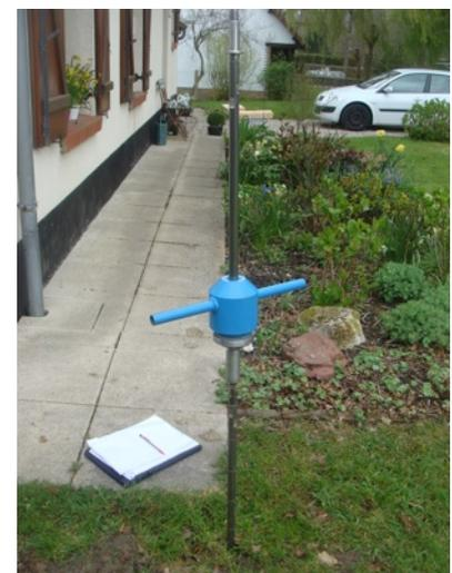
Fig. 1.13 Essai au pénétromètre dynamique à main
