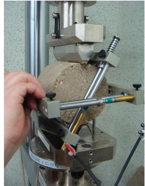
Fig. 1.9 Mesure de la résistance en compression diamétrale Rtb sur éprouvettes 10x10cm.
