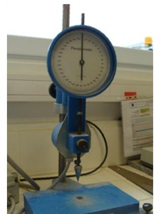
Fig 1.4 Cône de pénétration
