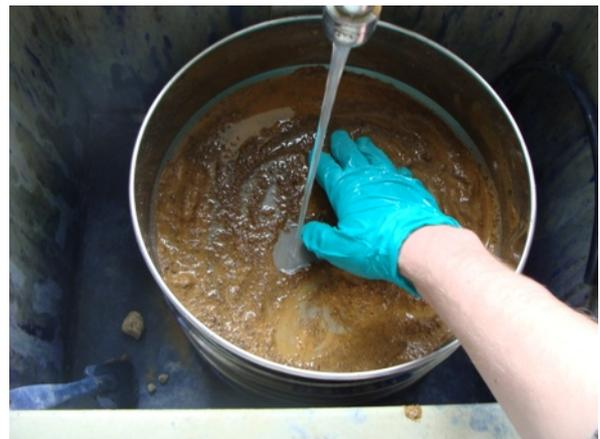
Fig 1.2 Lavage du sol analysé au tamis de  $80\mu\text{m}$ .
