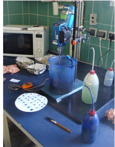
Fig 1.3 Essai au bleu de méthylène
